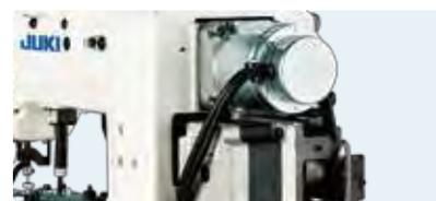
La testa cucitrice ha un sistema a trasmissione diretta (senza cinghia) che consiste in un servomotore AC compatto collegato alla macchina, che offre rapidità di risposta alle accelerazioni oltre ad una fermata istantanea e precisa.
