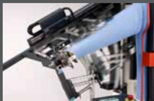
Regolazione elettronica della forza di tensionamento delle maniche, con possibilità di aggiustamento in manuale.
